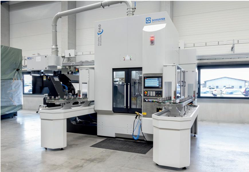
Bild 1. Schuster Maschinenbau setzt bereits seit vielen Jahren auf Fertigungsmesstechnik von BLUM. Auf der flexiblen Drehzelle F40 kommt beispielsweise der Messtaster TC61 zum Einsatz. © Blum-Novotest GmbH
